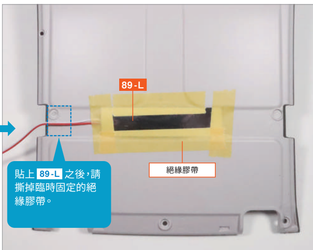
撕下鍍銀貼片 89-L 背面的底紙，將其覆蓋在 44-B (J16、紅/白) 的 LED 部分上並貼合。如果貼合不夠牢固，可以在 89-L 周圍貼上絕緣膠帶進行加固。
